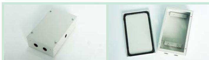
Корпуса Ш-101 и Ш-102 в основном используются для коммутационных и распределительных коробок. Они выполнены из стали 1 мм с покрытием цинкосодержащим грунтом и нанесением порошковой краски. Крышка имеет надежное полиуретановое уплотнение.
